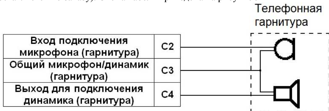
Рисунок 9. Кабель для подключения гарнитуры АВЛГ 816.33.00
