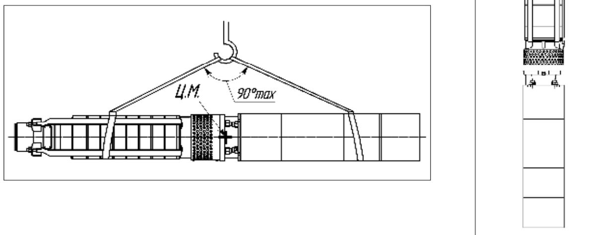
Рисунок 7 – Схемы строповки
