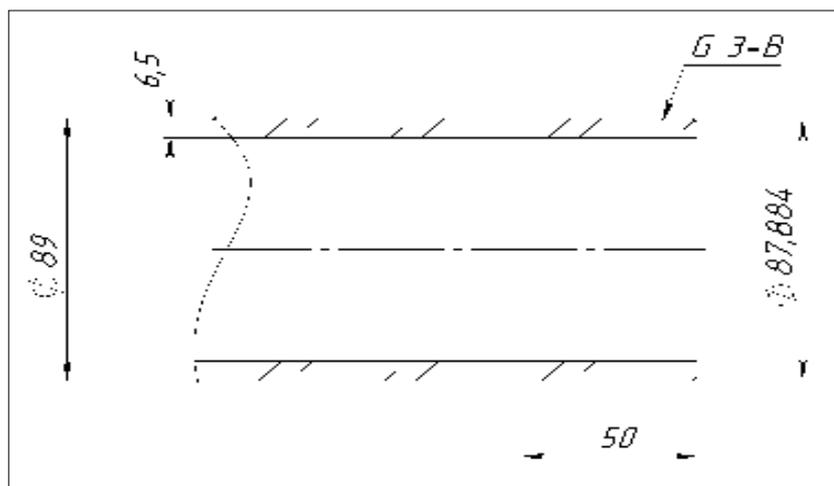
Рисунок 3- Присоединительные размеры трубы
