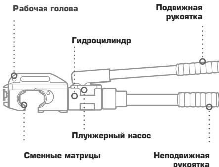
кое давление, но имеет малый расход рабочей жидкости. Вплоть до срабатывания АСД работает только вторая ступень высокого давления.
