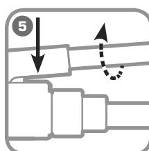
Для сброса давления поверните подвижную ручку и надавите ей на толкатель клапана сброса давления
