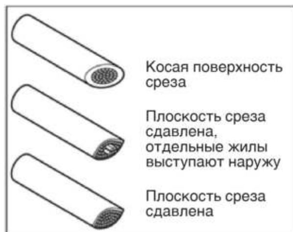
Рис. 11 Неправильная резка провода
