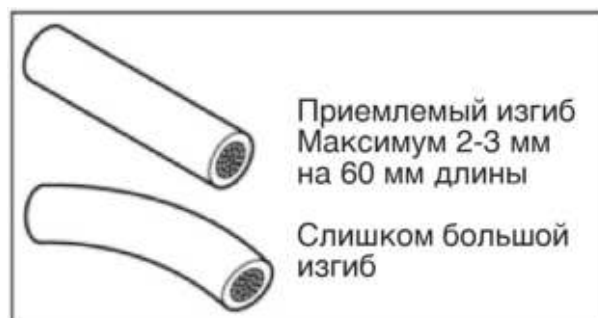
Рисунок 9 Выпрямление провода
